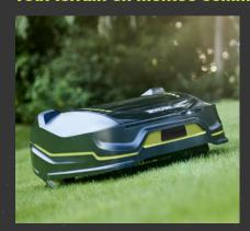
ROBOYAGI™ ne craint pas les terrains escarpés, pentus ou accidentés qui requièrent de la puissance pour hisser la machine et du freinage à la descente. Il peut gravir des pentes avec des inclinaisons allant jusqu'à 24°/ 45% (en montée et en descente) sans aucune difficulté, grâce à ses grandes roues arrière crantées et équipées de la motorisation Brushless. Il grimpe aisément les terrains inclinés sans glisser dans les dévers pour une tonte régulière quelle que soit la configuration du terrain.
